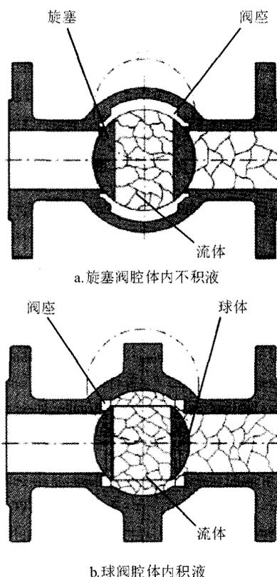
图 1 旋塞阀和球阀关闭时腔体内积液情况
